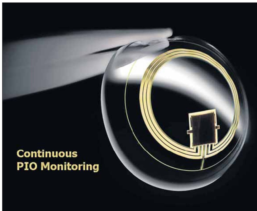
Este novedoso dispositivo envía datos de presión ocular de forma inalámbrica cada cinco minutos.
